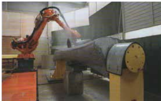
Mark Burry及Jane Burry 根據高第殘缺的手稿及模型，經過長年嚴謹的數學幾何研究，以3D模型重建極度近似原設計的各個部件，再以電腦輔助製造CAM生產，此流程大幅縮短聖家堂的施工工期。(出處：Scripting Cultures, Mark Burry)
